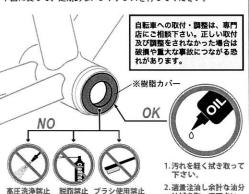
・高圧で洗浄されますと内部に水が浸入しベアリングが錆びる恐れがあります。・脱脂洗浄されますとベアリングに封入のグリースが溶け出し元に戻りません。
